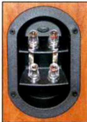
■ **MORSETTI** - La vaschetta posteriore per i collegamenti è di fattura abbastanza economica. I morsetti, isolati da materiale plastico trasparente, hanno le polarità contrassegnate in modo poco evidente e accettano cavo spellato di discreta sezione, anche se è sempre preferibile utilizzare forcelle o bananine.
