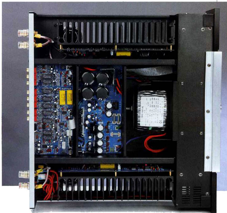
All'interno si nota la presenza di varie paratie metalliche longitudinali e trasversali che schermano le varie sezioni dell'apparecchio e irrobustiscono notevolmente il telaio. Il trasformatore toroidale di alimentazione è collocato a ridosso del pannello frontale, mentre i due ampi dissipatori di calore si estendono lungo i fianchi dell'apparecchio. Dietro il pannello frontale è visibile l'ampia scatola metallica che racchiude, insieme ad altri componenti, i due Vu-Meter ed il potenziometro motorizzato per la regolazione del volume.
